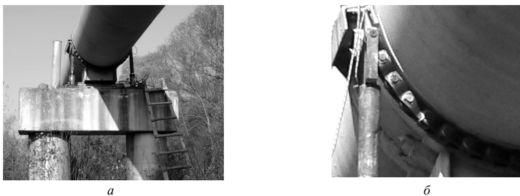
Рис. 1. Експериментальна модель гідравлічного підйомника із привідним ланцюгом: а – загальний вигляд; б – взаємодія роликів із трубопроводом
