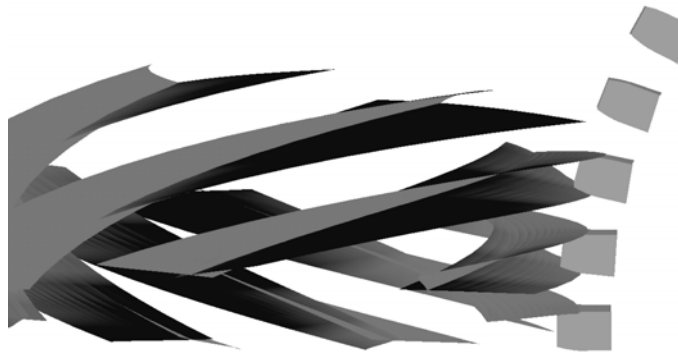
Рис. 4. Графическое представление зацепления гиперboloидного и исходного зубчатых колес, полученное OpenGL отрисовкой в программном пакете Eclipse SDK
