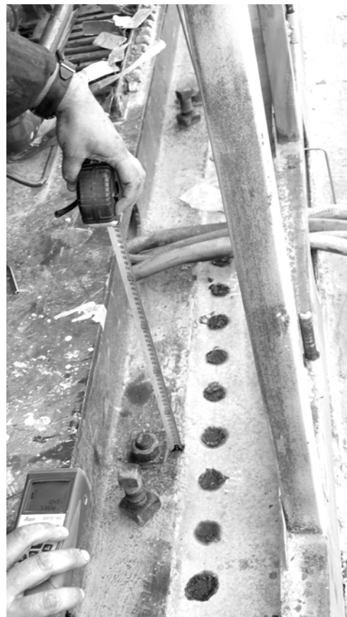
Рис. 5. Вимірювання кривини нижньої полочки поздовжньої металеві балки рами компресора лазерним далекоміром та рулеткою
