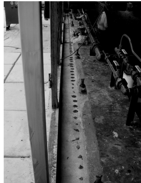
Рис. 8. Підготування поверхні підготовки вздовж балки Б-1 рами компресора для зондування бетону ультразвуковим методом. Нанесене мастило для поліпшення контакту ультразвукових датчиків
