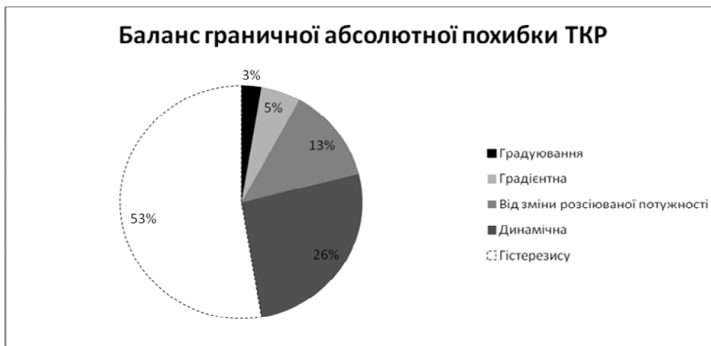
Рис. 2. Баланс складових граничної абсолютної похибки вимірювання температури ТКР
