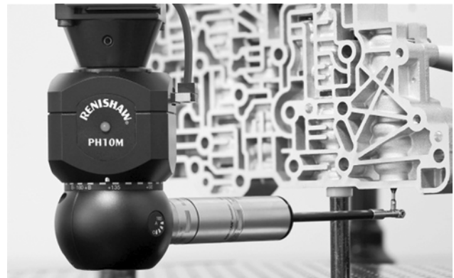
Рис. 12. Контактний 3D-сканер Renishaw SP25M у процесі оцифрування
