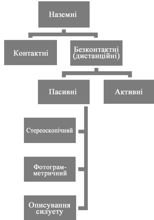
Рис. 11. Класифікація 3D-сканерів за технологією сканування
