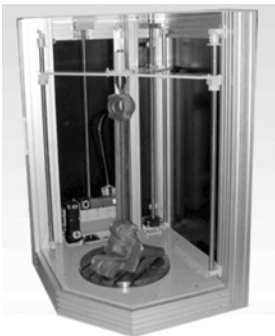
Рис. 9. Частково закритий лазерний 3D сканер від “Дизель-тест-комплект”
