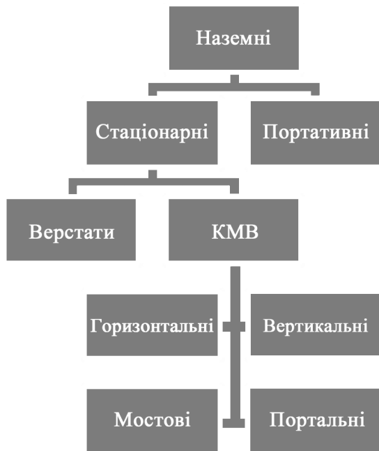
Рис. 2. Класифікація наземних 3D-сканерів за способом встановлення сканера
