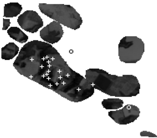
Рис. 5. Просторовий розподіл імовірності помилки за результатами інтеграції дистанційних та геолого-геофізичних даних
