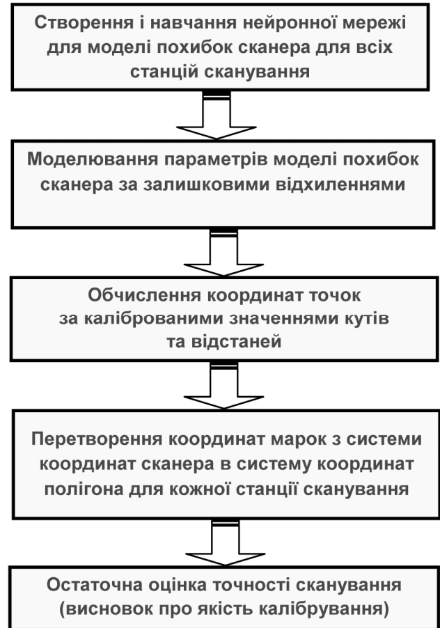
Рис. 2. Технологічна схема етапу калібрування сканера
