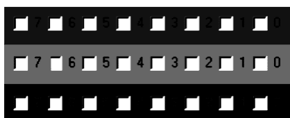
Рис. 1. Складові кольору 24-бітового формату BMP
