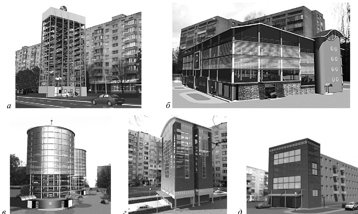
Рис. 8. Пропозиції автора об'ємно-просторових рішень паркінгів для міста Львова: а – автоматизований паркінг на 50 машино-місць на вул. Княгині Ольги; б – рамповий паркінг на 295 машино-місць на вул. Тролейбусна; в – автоматизований паркінг на 96 машино-місць на вул. Тролейбусна; г – автоматизований паркінг на 96 машино-місць на вул. Наукова; д – автоматизований прибудований паркінг на 36 машино-місць на вул. Наукова
