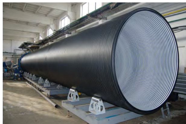
Рис. 1. Поліетиленова труба із пустотілою (стільниковою) будовою стінки
