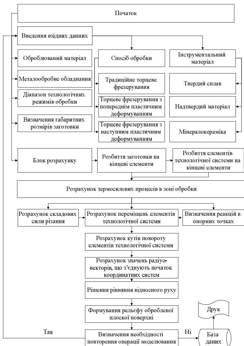
Рис. 4. Алгоритм роботи математичної моделі формування рельєфу обробленої плоскої поверхні комбінованим торцевим фрезеруванням
