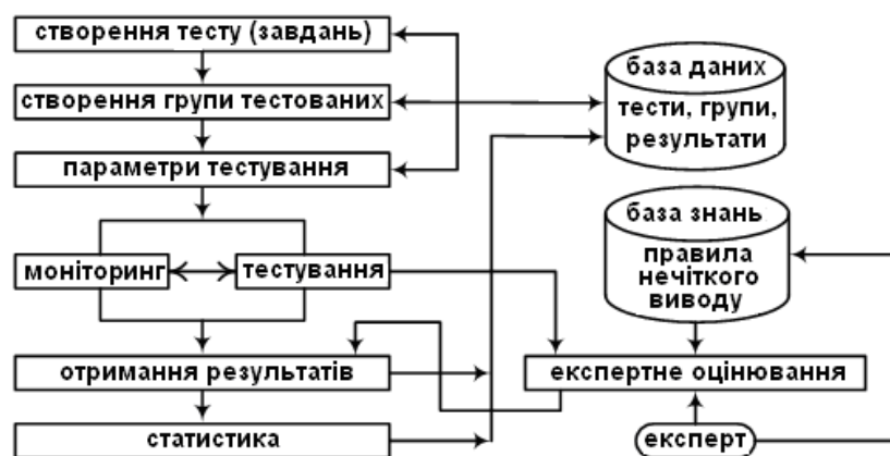
Рис. 1. Структура системи OpenTEST2 з модулем експертного оцінювання
