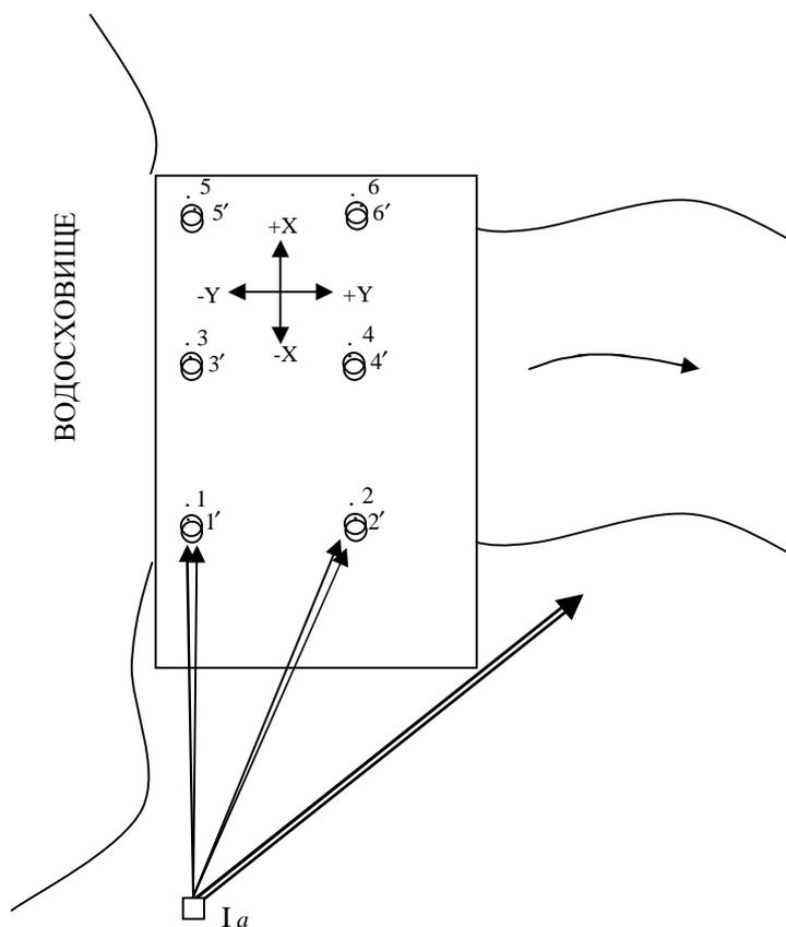
Рис. 1. Схема спостережень за горизонтальними зміщеннями плит перекриття водозливної греблі Добротвірської ТЕС:
