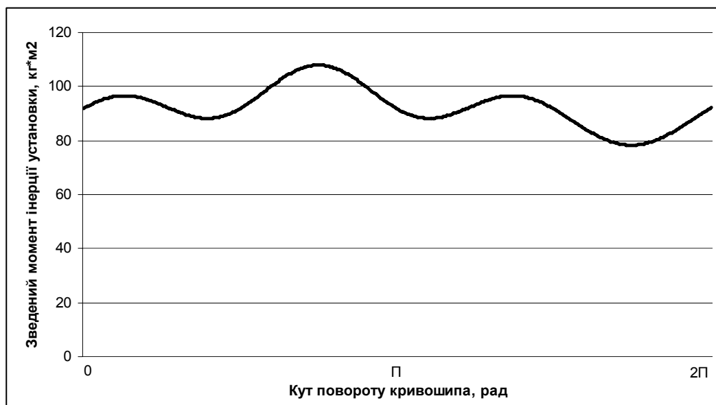
Рис. 3. Графік зміни зведеного моменту інерції установки від кута повороту кривошипа
