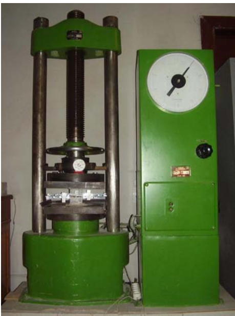
Фото 4. Визначення міцності матеріалу аеродромного покриття
