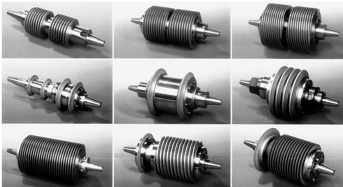
Рис. 2. Інструменти для шліфування зубчастих коліс на верстаті мод. LCS180
