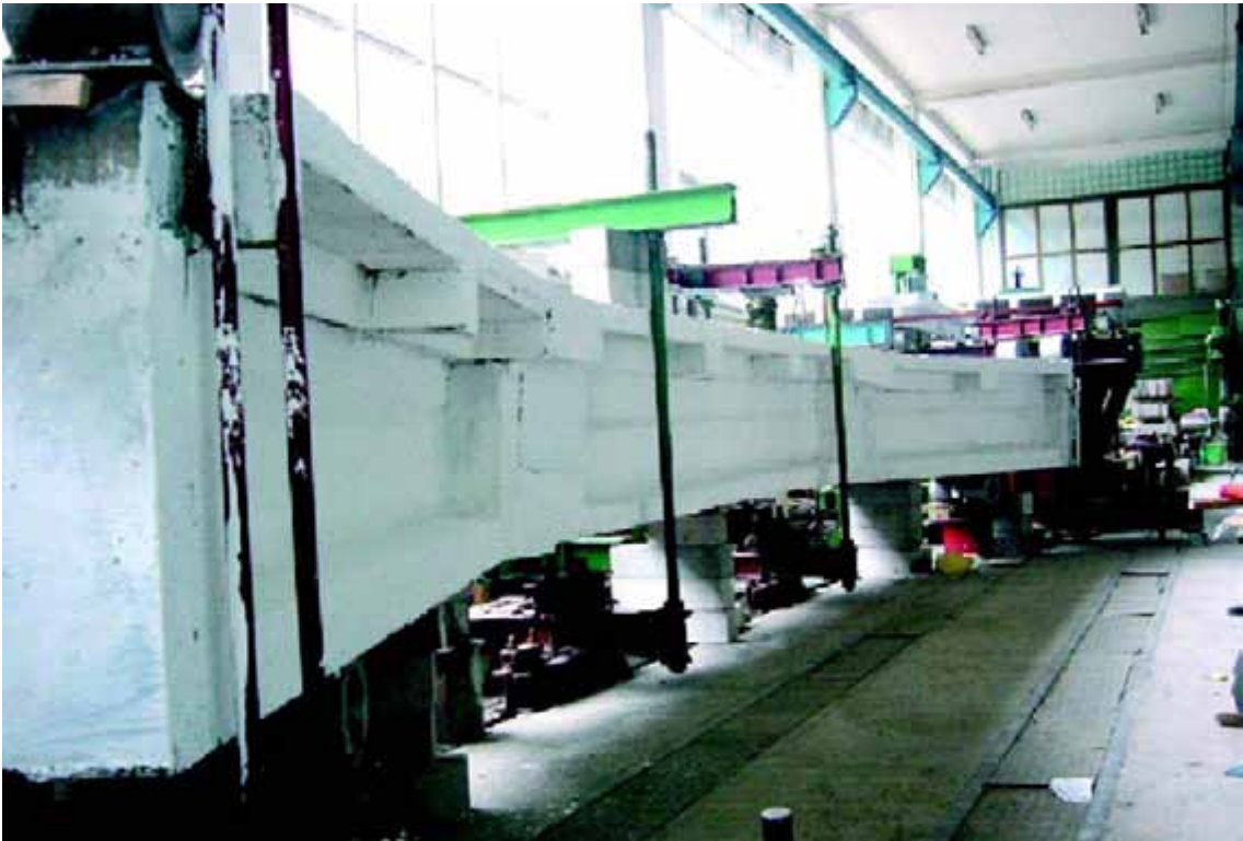
Рис. 27а. Загальний вигляд випробувань дослідної конструкції проганової будови естакади на кривій на випробувальному стенді
