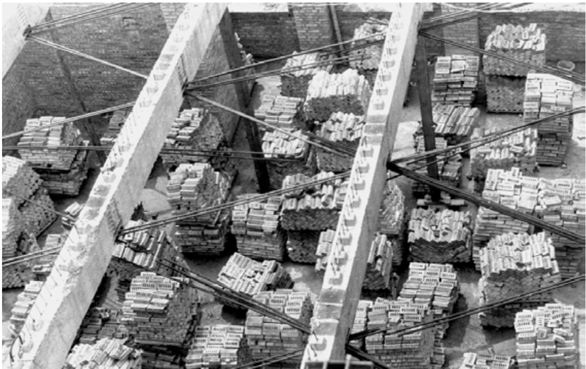
Рис. 49. Загальний вигляд випробувань збірно-монолітного кесонного перекриття актового залу (м. Львів, інститут “Містопроект”) (п. 34 в табл. 1)
