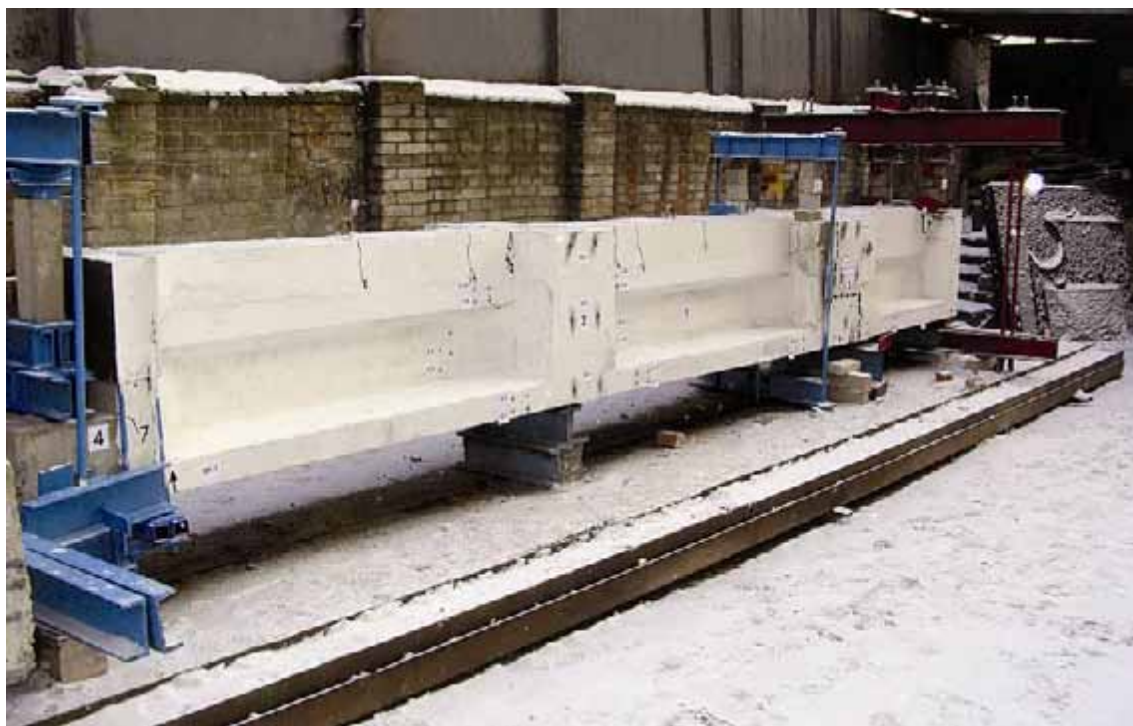
Рис. 27б. Загальний вигляд випробувань дослідної конструкції прогонової будови надпорної ділянки естакади
