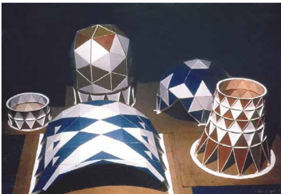
Рис. 28. Проектні пропозиції збірно-монолітних залізобетонних конструкцій інженерних споруд з використанням трикутних ребристих плит: резервуарів, аркових перекриттів підземних споруд, силосів з великим діаметром, купольних ребристих перекриттів, градирні та споруд баштового типу
