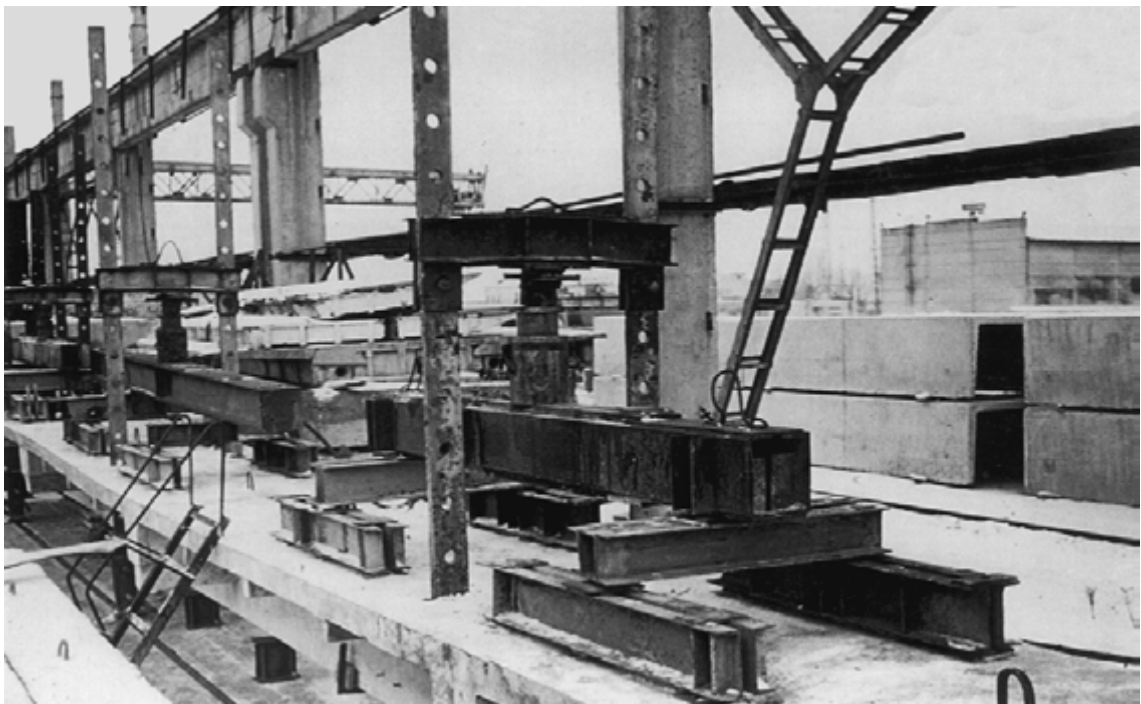
Рис. 45. Загальний вигляд випробувань дослідної одноконсольної збірно-монолітної конструкції БКСМ-15-6 (п. 29 в табл. 1)
