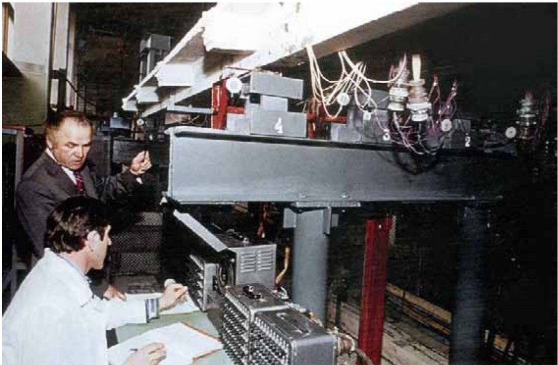
Рис. 25. Загальний вигляд випробувань дослідної конструкції прогонової будови моста НМ-2 3-3 в лабораторії Національного університету "Львівська політехніка"
