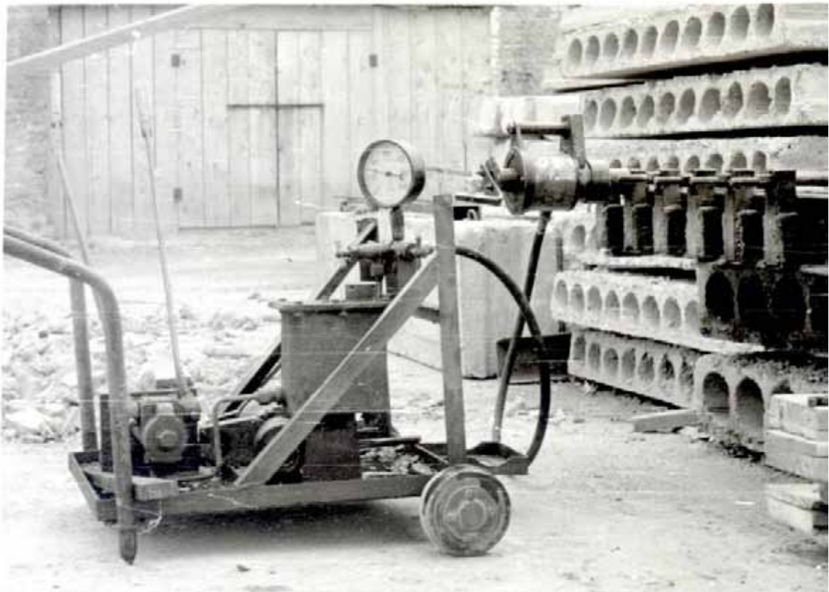
Рис. 5. Натяг стрижневої арматури на упори силових форм за допомогою гідравлічних домкратів
