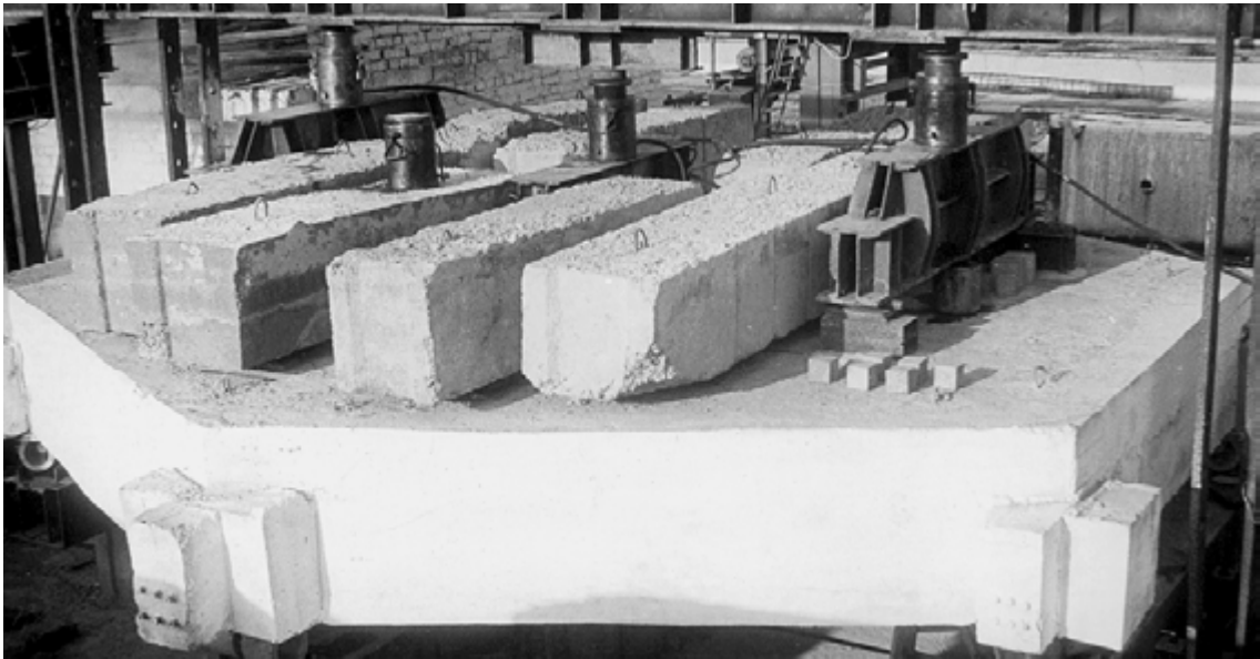
Рис. 42. Загальний вигляд випробувань дослідної конструкції шестикутного фрагмента розмірами b \times b м для ЗМКП (п. 25 в табл. 1)
