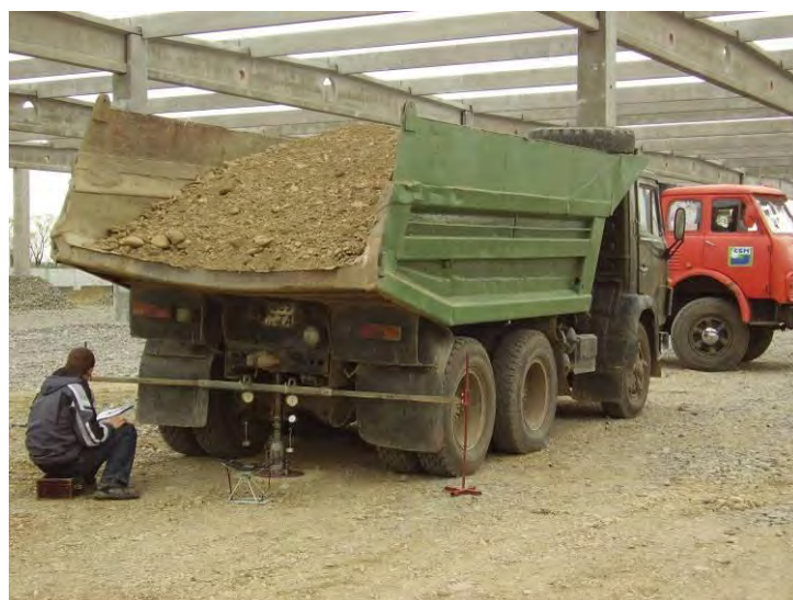
Рис. 6. Натурні експериментальні дослідження штучної основи, підготовленої під покриття підлоги торгового центру “Арсен” (м. Стрий, Львівської області)
