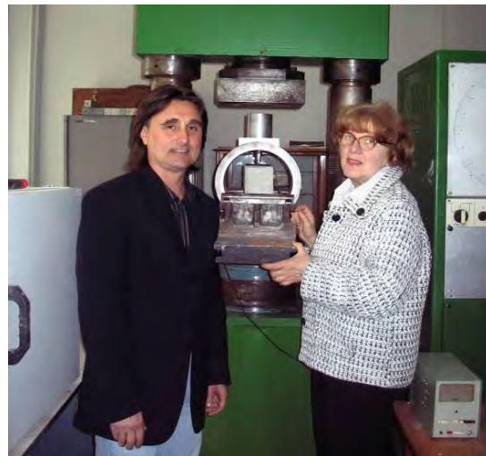
Рис. 3. Доц. С.Й. Солодкий, ст. викл. Л.О. Карасьова біля випробувальної установки дослідження тріщиностійкості дорожніх бетонів методом механіки руйнування
