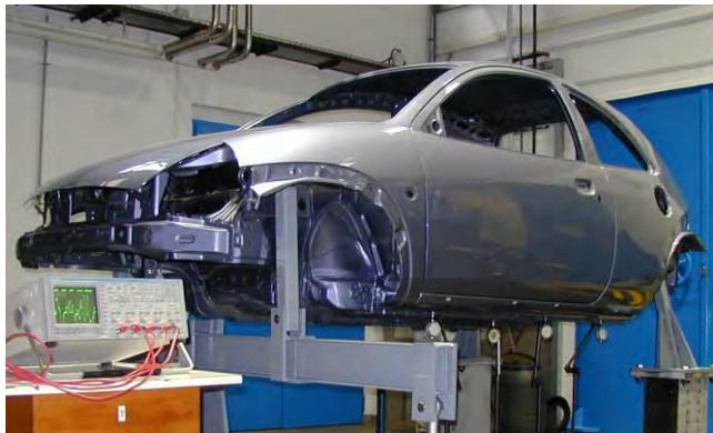
Спільно з німецькими колегами розроблена теоретично-експериментальна методика оцінки власних частот кузовів автомобілів
