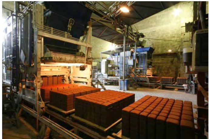
Рис. 2. Впровадження технологій ущільнення наджорстких бетонних сумішей для вібропрасування фігурних елементів мощення на заводі Залізобетонних конструкцій ім. С. Ковальської, м. Київ
