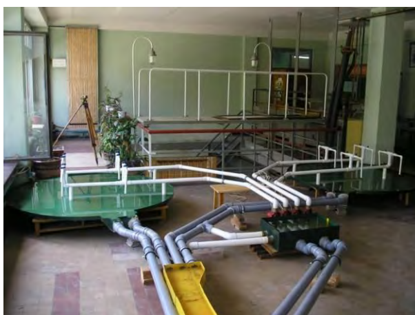
Рис. 5. Фізична модель системи оборотного водопостачання АЕС
