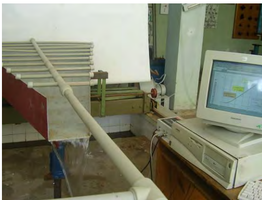
Рис. 4. Експериментальна установка для дослідження закономірностей формування дощового стоку в режимі on-line
