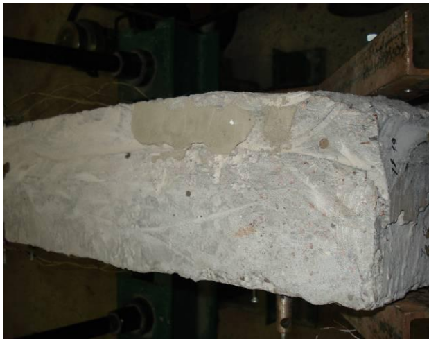
Рис. 3. Видяк дослідної підсиленої торкретуванням залізобетонної балки в лабораторних умовах
