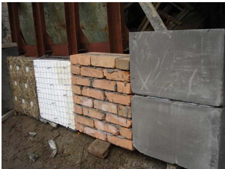
Рис. 5. Дослідні зразки із соломи, пінополістиролу, цегли і пінобетону, підготовлені під торкретування
