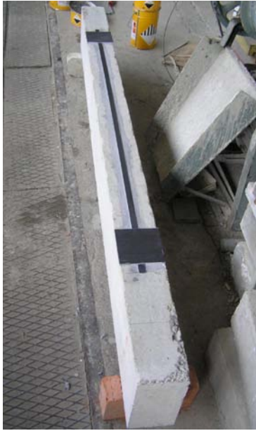
Рис. 3. Експериментальний зразок з наклеєною стрічкою CFRP та системою анкеруючих пластин
