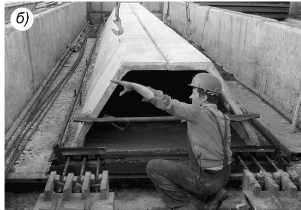
Фото 4. Виготовлення пустотної складчастої панелі а – армування плити; б – установка на свіжосформовану плиту готової складки
