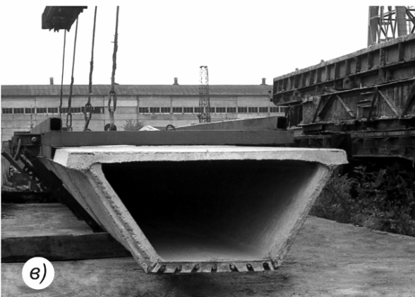
Фото 5. Кантування складчастого настилу: а, б, в – пустотний складчастий настил під час кантування
