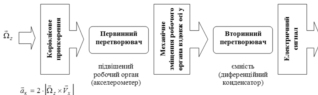
Рис. 4. Блок-схема перетворення механічного руху в електричний сигнал для опису мовою VHDL-AMS
