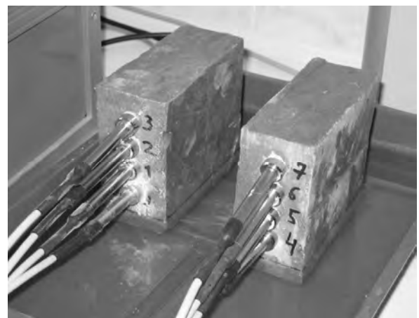
Rys. 6. Przebieg badania – próbki z sondami
