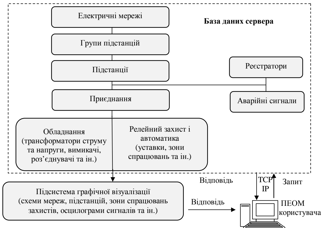
Рис. 5. Структурна схема інформаційних об'єктів підсистеми аналізу аварійних ситуацій
