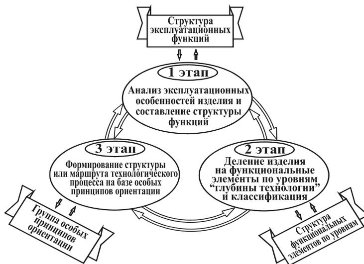
Рис. 6. Основные этапы синтеза функционально-ориентированных технологических процессов
