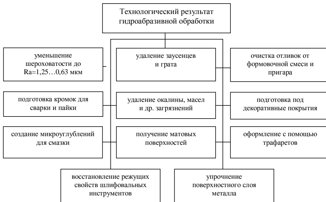
Рис. 1. Технологический результат, достигаемый отделочно-зачисной гидроабразивной обработкой
