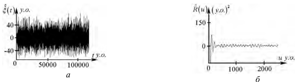
Рис. 3. Стохастична складова сигналу (а) та оцінка кореляційної функції її стаціонарного наближення (б) ( \Delta l / l = 0.1 )
