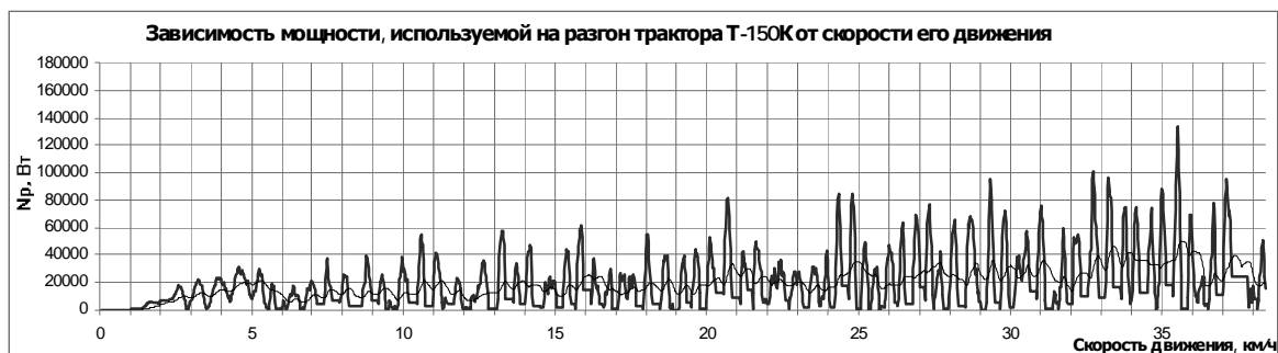
Рис. 4. Графік залежності зміни потужності двигуна в процесі розгону агрегата
