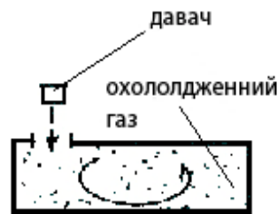
Рис. 8. Принципова схема установки для створення тільки холодного термоудару
