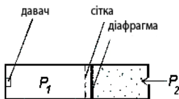
Рис. 1. Принципова схема установки для створення одночасного удару тиску і холодного термоудару
