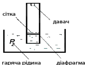
Рис. 3. Принципова схема установки для створення одночасного удару тиску і гарячого термоудару
