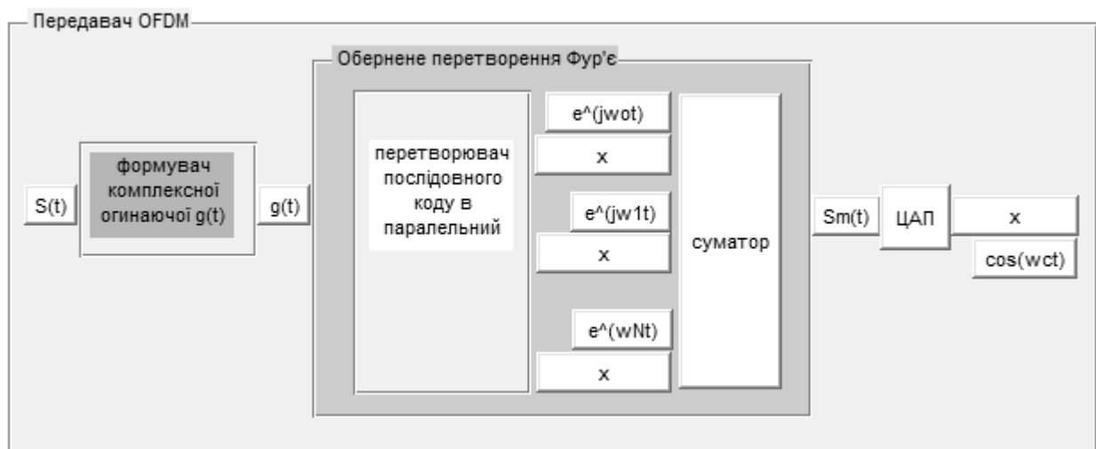
Рис. 11. Функціональна схема передавача OFDM
