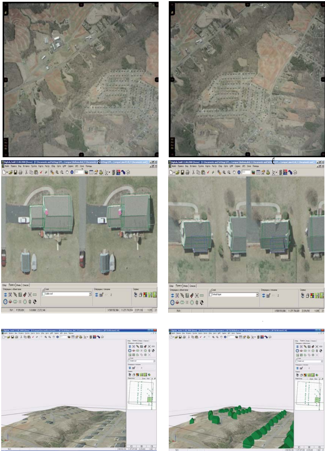
д) е) Мал. 2. Створення віртуальної моделі місцевості за стереопарою фотограмметричних знімків в програмі Digital/Delta for Windows V 5.0 Prof (Demo). а), б)-стереопара знімків М 1:8000 (знятих камерою RMK TOP 15, f=145.860 mm); в), г)-вимірювання будівель за шаблонами; д)- синтез зображень ЦМР та текстури зорієнтований знімок); е)- синтез 3D моделі рельєфу і шару об'єктів „будівлі”;
