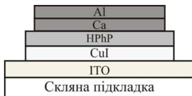
Рис. 2. Структура органічного світлодіода ITO/CuI/HPhP/Ca:Al
