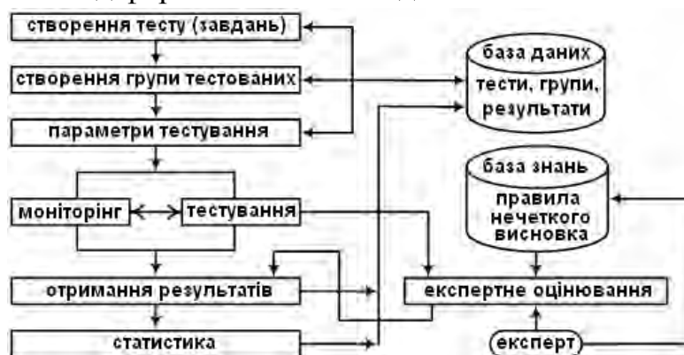
Рис. 1. Структура системи OpenTEST2 з модулем експертного оцінювання
