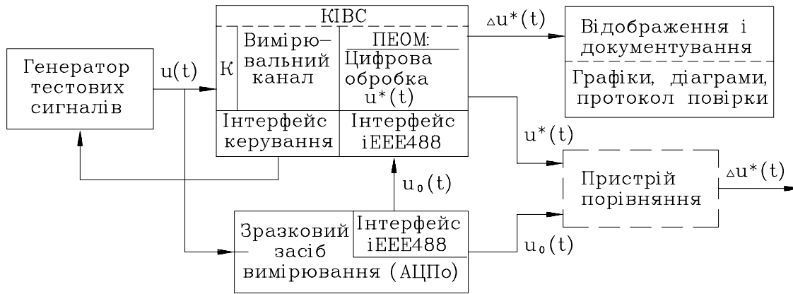
Рис. 1. Схема повірки з використанням зразкового засобу вимірювання
