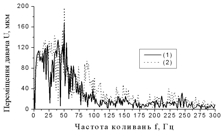
Рис. 6. Спектри частот руху диска-сепаратора пружно-коливної системи основа – статор – диск-сепаратор (робочий режим роботи електромагнітного віброзміцнювача) за відповідних значень сили струму на котушках електромагнітів : I_1 = 0,75 \text{ A} , I_2 = 1,0 \text{ A}
