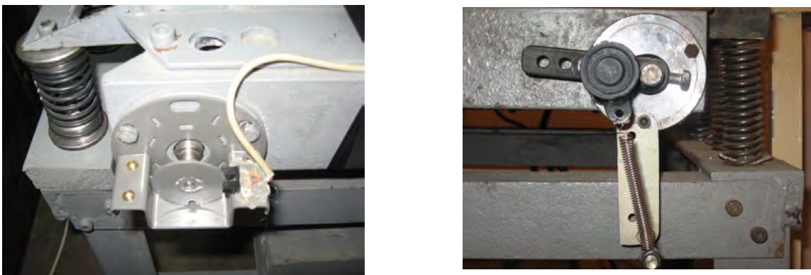
Рис. 3. Щільовий фотодатчик, закріплений біля торця ротора збудника (а); удосконалений пристрій для підсилення ефекту кратної самосинхронізації (б)
