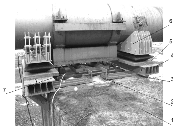
Рис. 2. Підймальна установка: 1 – бетонна опора; 2 – консоль; 3 – опорні балки; 4 – опорна плита; 5 – пневмоподушка; 6 – призма; 7 – індикатор висоти підйому
