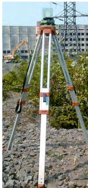
Рис. 4. Закрепление сканерной марки на подставке, установленной на штативе
