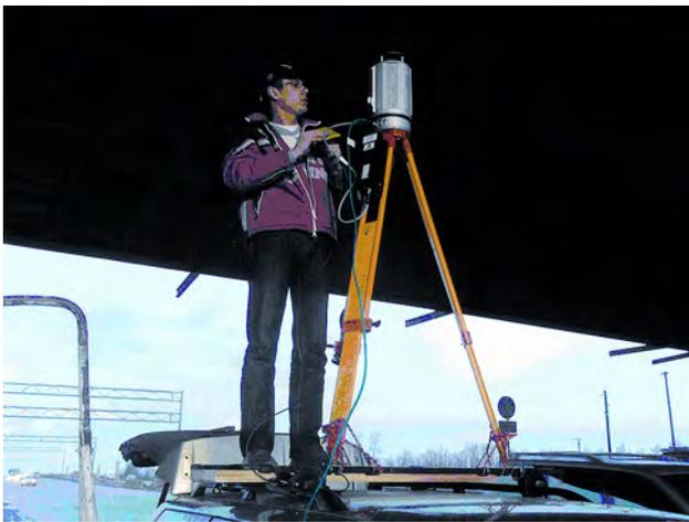
Рис. 2. Установка сканера на автомобиле
