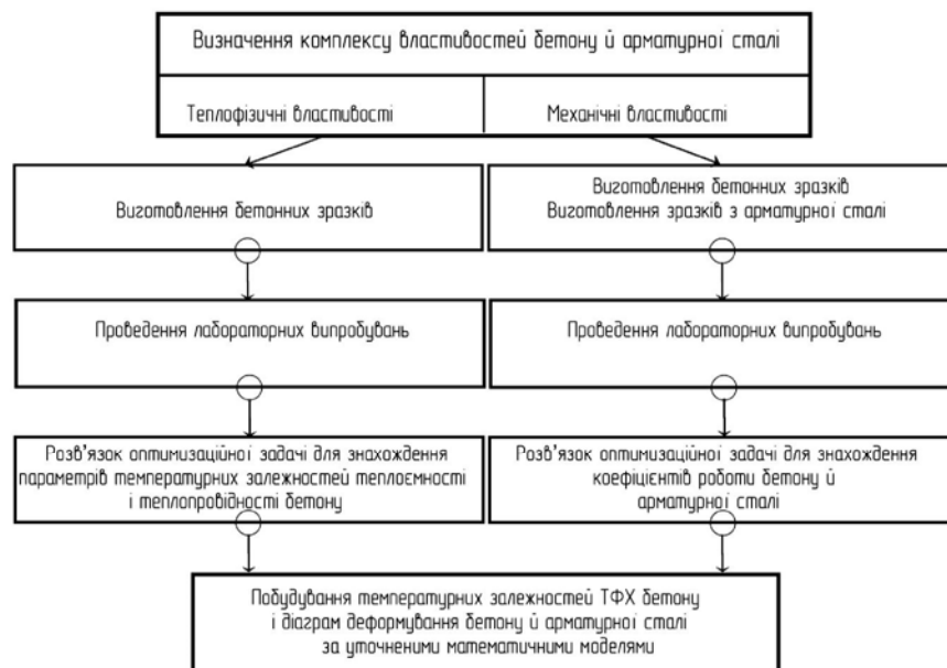
Рис. 2. Структурна схема експериментально-розрахункового методу визначення комплексу теплофізичних і механічних властивостей бетону і арматурної сталі
