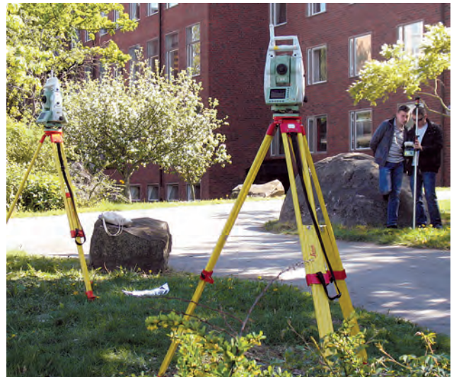
Практичні заняття – робота з дистанційно керованими електронними тахеометрами Leica TCRP1201
