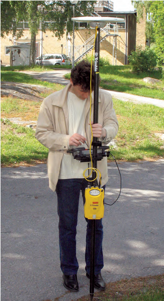
Олександр Заяць виконує вимірювання ГНСС-приймачем Trimble у режимі RTK
