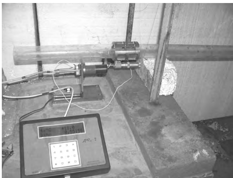
Рис. 1. Вимірювальний блок і безконтактний ємнісний датчик деформометричної системи на короткому (задовжки 6,5 м) деформографі в штольні РГС “Берегове”
