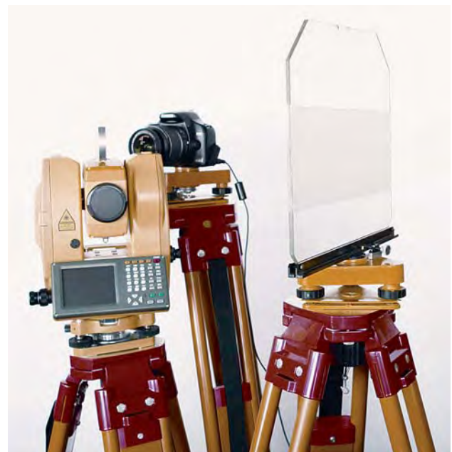
Рис. 2. Загальний вигляд розташування приладів під час визначення еквівалентної фокусної віддалі цифрових неметричних камер
