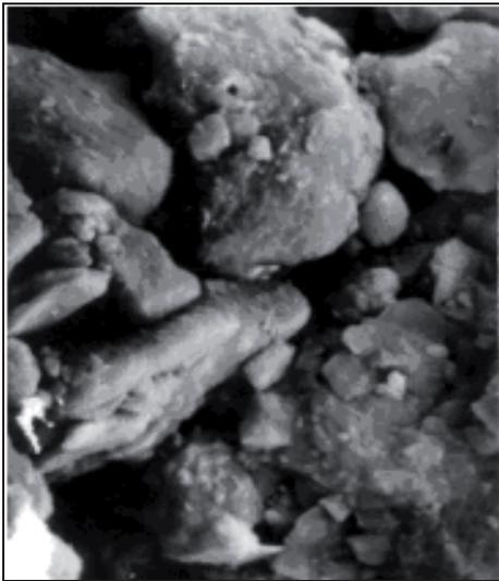
Рис. 2. Мікрофотографія (збільшення 1100) бідисперсної глобулярної мікроструктури
