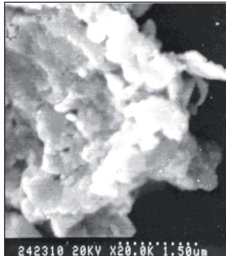
Рис. 4. РЕМ-мікрофотографії зразків ХАЕС та зовнішнього виду органоглинистих включень (округлої форми  $\varnothing$  10...15 мм, скв.3, гл.15 м). Збільшення 350, 2000, 20 000 крат (досліджуване місце виділене прямокутним вікном)
