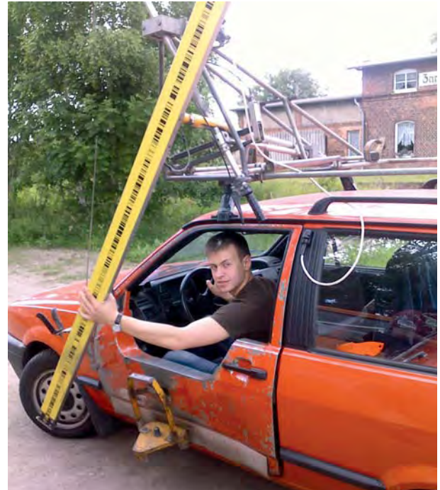
Студент Євген Лавришко виконує моторизоване нівелювання
