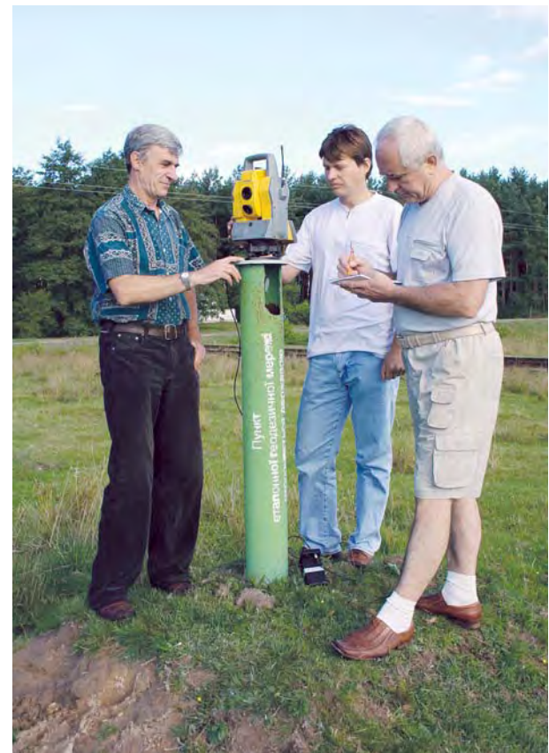
Рис. 6. Вимірювання ліній базису електронним тахеометром Trimble 5601 DR Standart
