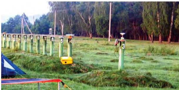
Рис. 3. Фазова частина еталонного базису
