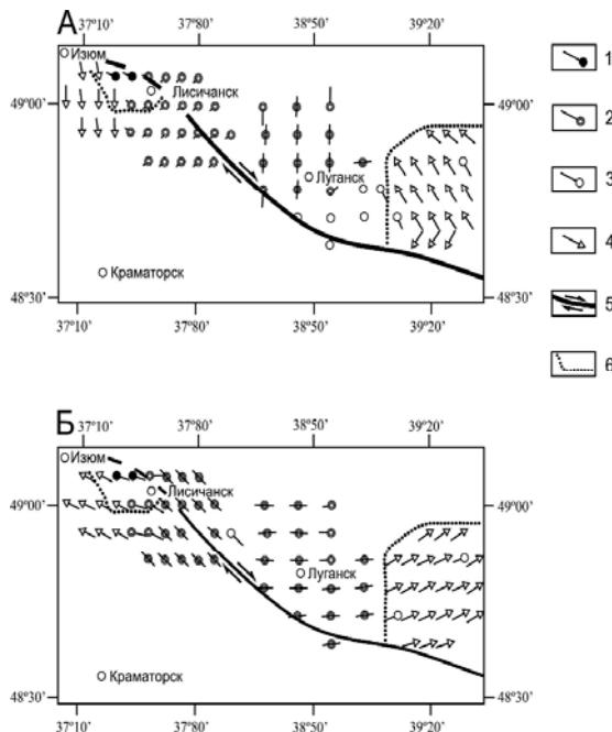
1-4 – горизонтальные проекции осей напряжений/деформаций (погружение оси направлено от точки), типы стресс-режима (по данным определения коэффициента Лоде-Надаи): 1 – взбросовый, 2 – сдвиговый, 3 – сбросовый, 4 – “октаздрический” (все главные оси напряжений/деформаций наклонены под приблизительно равными углами порядка  $45^0$ ), 5 – линия Северодонецкого разрыва (изображена схематически), 6 – контуры квадрантов сжатия в зоне Северодонецкого разрыва.
