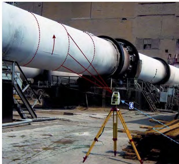
Рис. 1. Принцип измерения печей электронным тахеометром
