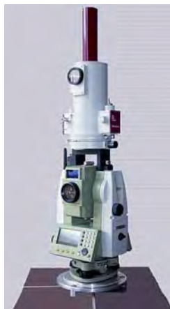
Рис. 2. GYROMAX на базі приладів Leica
