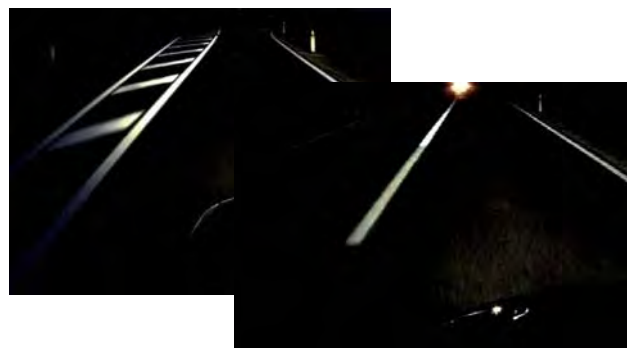
Bild 10. Nachtsichtbarkeit von Fahrbahnmarkierungen
