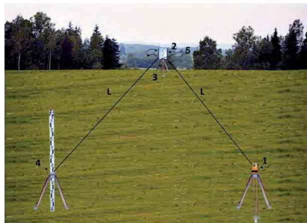
Рис. 2. Спосіб визначення вертикальної рефракції з використанням плоского дзеркального відбивача, який має можливість нахилу у вертикальній площині
