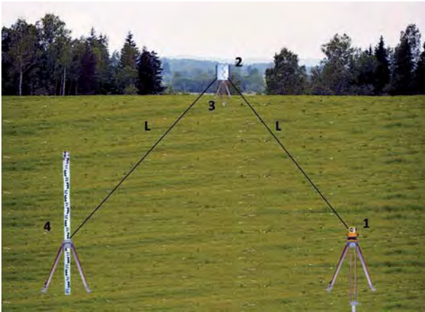
Рис. 1. Схема реалізації способу визначення вертикальної рефракції з використанням плоского дзеркального відбивача
